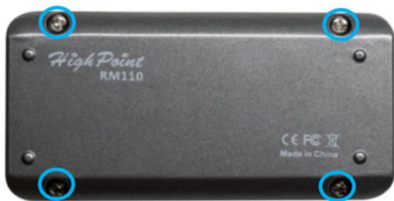
**注意：** 确保顶部面板正确对齐，并牢固固定在外壳上。未对准或安装不牢固的面板可能会妨碍RocketMate 正常工作，或阻止机柜正确冷却 M.2 NVMe SSD。不安全的连接或过热可能会导致 NVMe 介质或控制器硬件损坏、性能降低，或导致不稳定的 I/O 和数据丢失。
