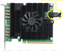
RU1388D 通过两个电源来支持 8 个 USB 设备,通过 PCIe 总线控制,并通过外部 6 针 PCIe 电源线供电。如果外部电缆未连接,则电源将不足以支持 8 台 USB 设备,这可能会导致 USB 设备下线。
