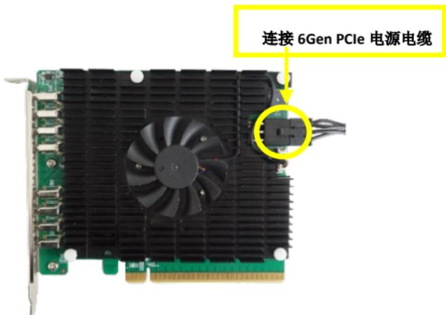
RU1488C 依靠两个电源来支持 8 个 USB 设备，通过 PCIe 总线供电，并通过外部电源线从系统的 PSU 供电。如果外部电缆没有连接，则电源将不足以支持 8 个 USB 设备，这可能会导致 USB 设备脱机。
