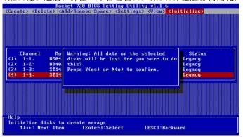
d. 初始化后,这些硬盘的"Status"显示为: "Initialized",可以用于创建RAID阵列。 Note:初始化将销毁所选硬盘上已存在的数据,所以不要初始化有重要数据的硬盘。
