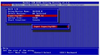
Note:可以使用同一组硬盘驱动器创建多个RAID阵列,(Rocket 720 BIOS中,每个硬盘驱动器最多可创建2个RAID阵列)。"Capacity(GB)"选项允许留出用于创建另一个RAID阵列、添加为备用磁盘或者分区作为单个磁盘(通过系统操作)的容量。
