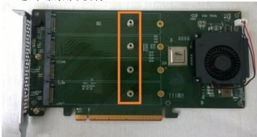
步骤三 SSD应该从上到下安装，卸下顶部螺丝
