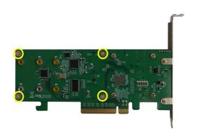
注意: 在将铝盖与控制板重新固定到SSD7202之前,请确保其与控制板(PCB)正确对齐,并与热垫完全接触。如果盖子安装不当,热垫将无法充分冷却NVMeSSD和控制器组件,这可能导致SSD或控制器硬件损坏、性能损失、不稳定的I/O和数据丢失。
