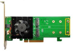
步骤 4. 请拆下SSD7202右侧的螺钉
