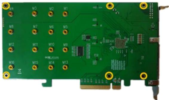
步骤2. 卸下螺钉后，小心地从控制器卡上卸下散热器。小心地将散热器翻转过来以查看散热垫。在重新安装面板之前，必须从垫子上取下蓝色薄膜。该薄膜可在安装前保护焊盘免受损坏和异物的侵害，但还可以防止焊盘将热量从NVMe SSD和控制器组件中转移出去。
