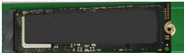
步骤6. 重新拧紧螺钉以固定固态硬盘。
