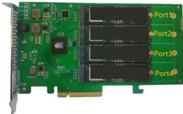
步骤7. 安装所有固态硬盘后更换散热器
